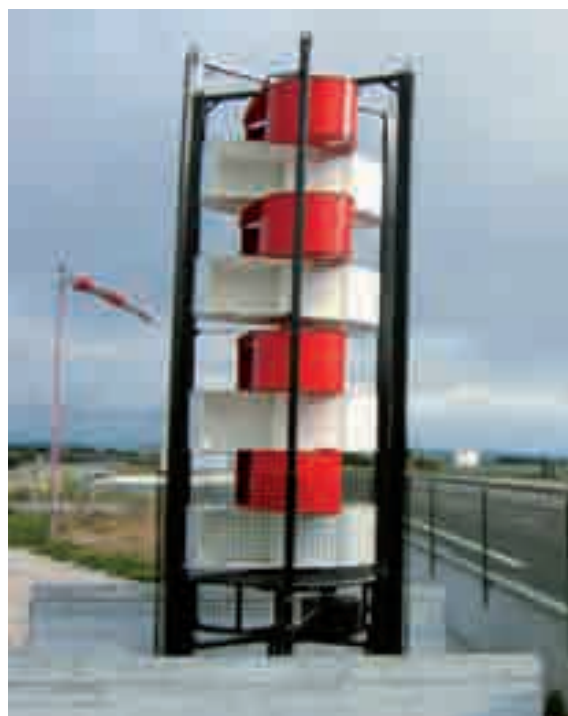
Nouveau prototype d'éolienne à axe vertical testé aux abords de l'autoroute A6, dans la région d'Auxerre (APRR).
