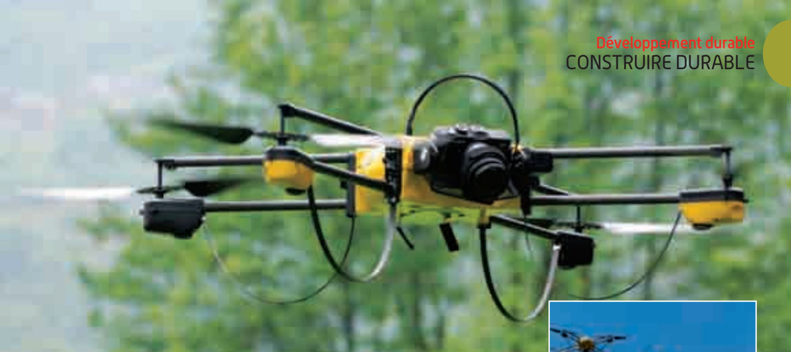
Le drone photographie et filme en haute définition des ouvrages difficiles ou impossibles d'accès (Eiffage Énergie).
