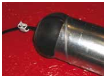
Figure 64 : UTILISATION D'UNE VESSIE POUR OBTURER UNE BOUCHE LORS D'UN TEST - source Etamine
